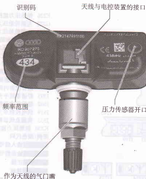
图 4-11 车轮电控装置
