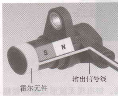
图 1-13 霍尔式轮速传感器
