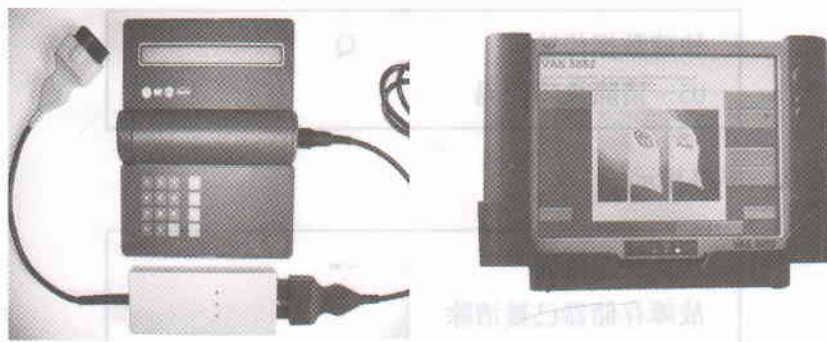
图 1-8 检测仪 V. A. G1551 与 V. A. S5052
