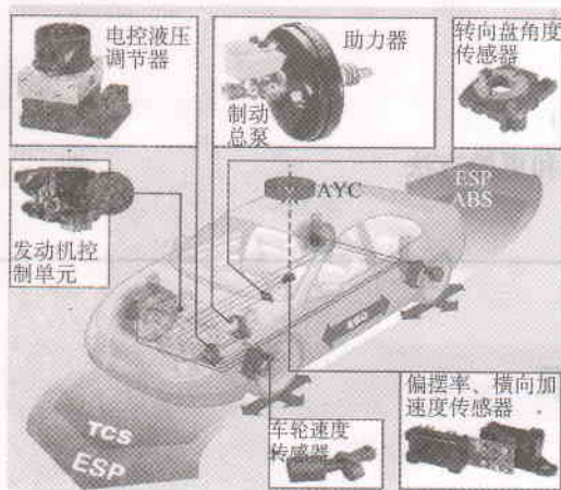
图 2-2 ESP 组成和各部件实车位置
