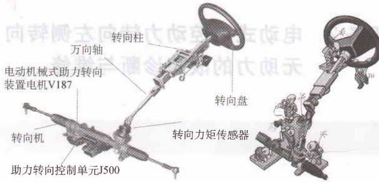
图 5-6 大众电动式电控转向系统的基本组成
